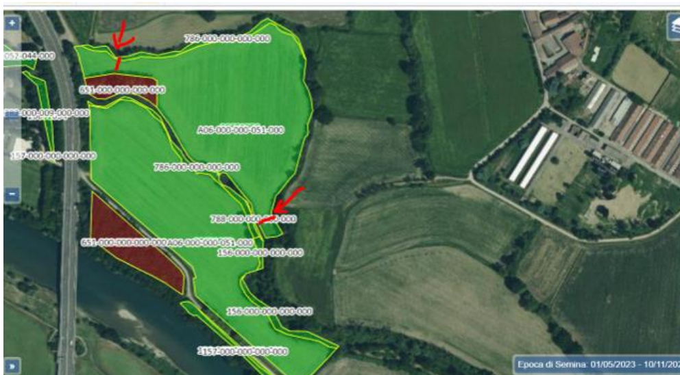
Figura 14 - esempio di appezzamento irregolare con parti di superficie con possibile larghezza minore a 20 m; la misurazione durante il rilievo dovrà interessare queste aree
